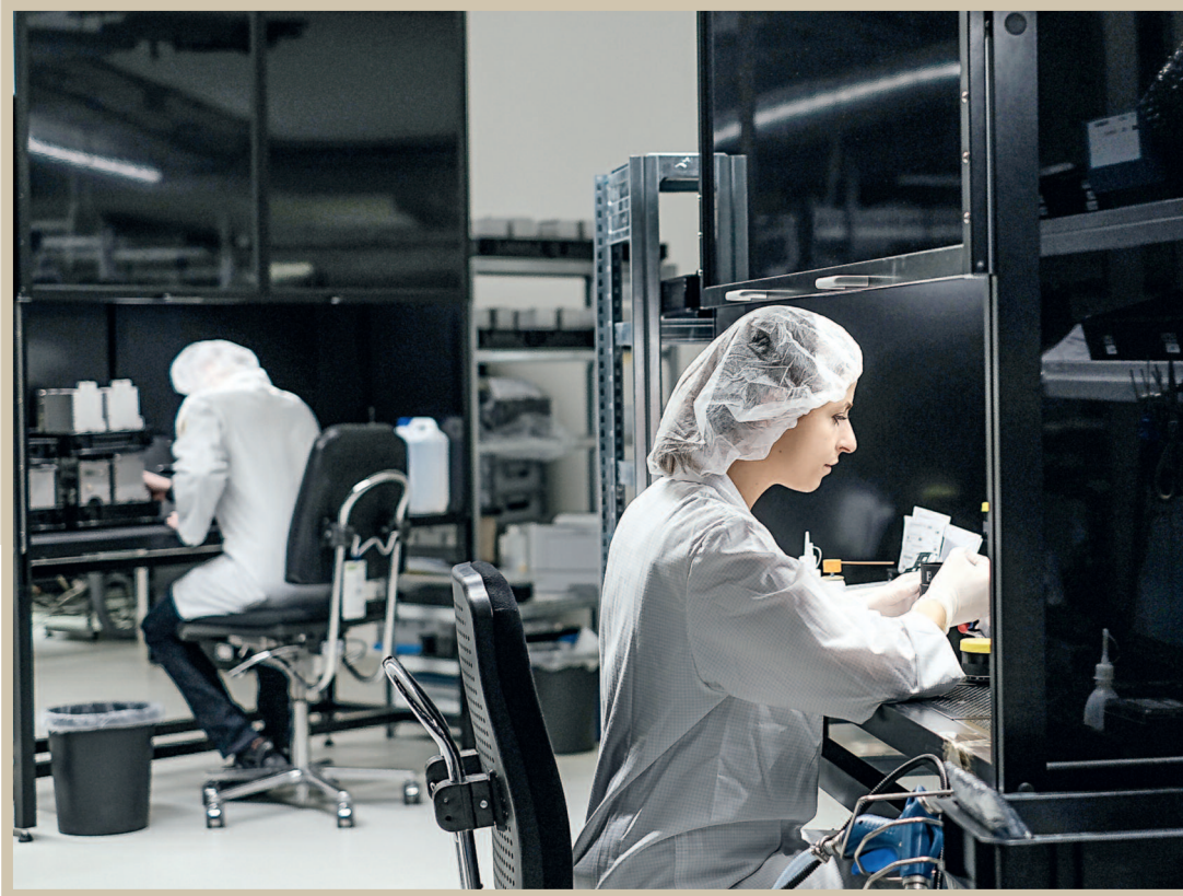
Bild 4. Montagearbeitsplätze mit Reinraumtechnik (Flow-Boxen)
