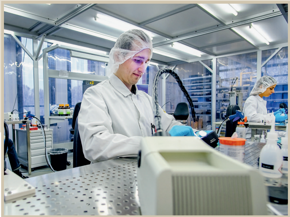
Bild 3. Arbeitsplatz mit Lochblech für mehr Sauberkeit in der Reinraumzone der Fertigung
