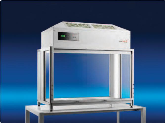
**Bild 3: Typische Laminar Flow Box**
