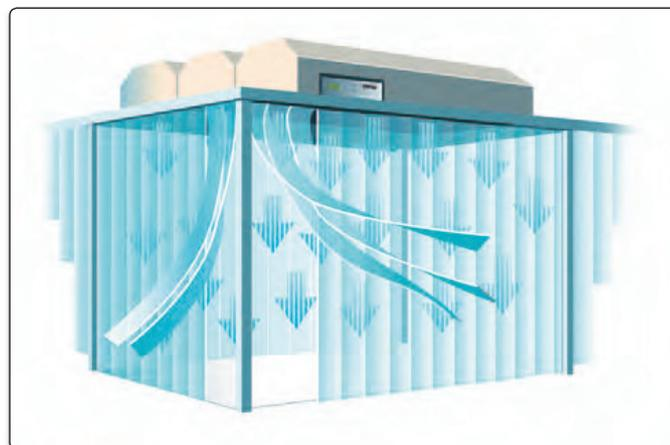
**Bild 2: Reinraumzelle mit drei Modulen**
