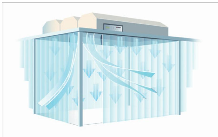
Abb. 4: In großen begehbaren Reinraumzellen sorgen mehrere Lüftungsmodule für laminare Reinluftzufuhr.
